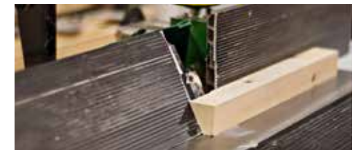
Ainutlaatuinen ominaisuus MF30:ssä- kallista taaempi pidike niin saat hyvän tuen viistojyrsintään.
