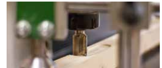
Jyrsi ura saranoille, esimerkki, miten voit käyttää pystyjyrsintä.
