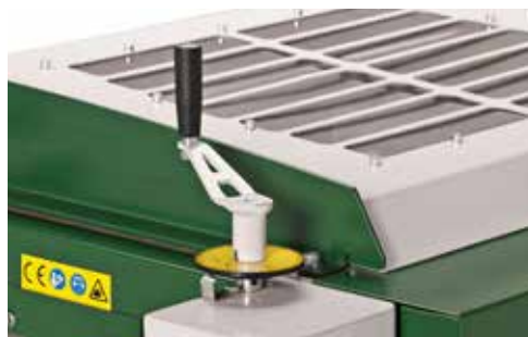
Kammen levy näyttää korkeusasetuksen 1/10 tarkkuudella.
